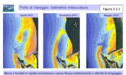
Barre alle sommerse imboccature dei porti o di foci armate: sabbie che si depositano sistematicamente di fronte imboccature dei porti esposti ad un trasporto solido longitudinale (longshore) in litoranei sabbiosi (Fig. 2.1.1); questi depositi sommersi possono essere movimentati con mezzi marittimi ed impiegati per il ripascimento mediante refluimento diretto (con draghe aspirantirefluenti) o refluimento indiretto (con
