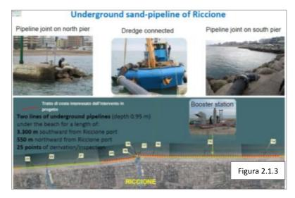
interventi di back-pass (ricarica delle spiagge sopraflutto via terra mediante dumper) ovvero di by-pass (ricarica delle spiagge sottoflutto) con l'ausilio di mezzi marittimi draganti e l'impiego di tubazioni tradizionali (amovibili ogob l'intervento) 0 fisse eventualmente equipaggiate di una pompa di rilancio (booster). Fra gli esempi di by-pass con tubazione fissa può essere citato l'esempio del Porto di Riccione (Fig. 2.1.3).
