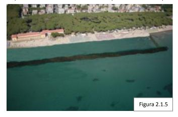
genere le più fini ed inoltre il profilo tenderà naturalmente riassumere conformazione naturale. Questo vale ancora di più per i dragaggi di avanspiaggia effettuati a batimetriche ancora minori. Nel dell'intervento a Follonica (Appalto SALES 2012), circa 70.000 m<sup>3</sup> sono stati prelevati fascia dalla di spiaggia sommersa immediatamente a ridosso (lato mare) della barriera sommersa di massi e collocati sulla spiaggia emersa (Fig.2.1.5).
