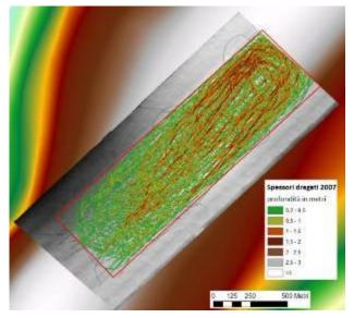
Figura IV.4.4.2.2 Calcolo degli spessori dragati nel 2007 nell'area C1
