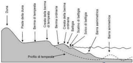
Figura IV.1.4.1.1 - Sezione tipo di una spiaggia<sup>38</sup>
