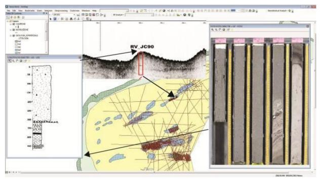
Figura IV.4.2.1: Esempio dei dati contenuti nel geodatabase: cartografia geologica, dati geofisici, foto carotaggio, log stratigrafico profilo sismico ad alta risoluzione etc.
