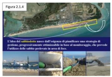
caricanti. Esempi di prelievi da barre alle foci fluviali o bocche lagunari con tubazione fissa sono quello in fase di realizzazione a Bibiona (VE) dove le sabbie vengono prelevate dalla foce del Tagliamento e quello in funzione a Lido di Volano (FE) con prelievo dallo Scanno di Goro (Fig. 2.1.4).
